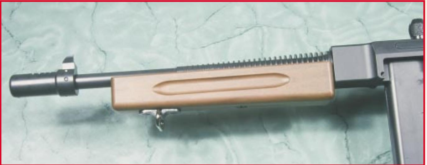
*Autre détail important entre les deux versions de la Thompson, c'est le garde-main : très classique sur la M1A1, alors qu'il est remplacé par une poignée sur la 1928 Drum Rifle.*
