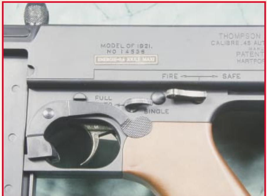
Gros plan sur le système de sécurité. Il existe deux positions : « Fire » pour le tir et « Safe » pour la mise en sécurité. Notez la présence d'un deuxième bouton fictif, comprenant les mentions « Single » et « Full ». On remarquera aussi le bouton d'éjection du chargeur qui se trouve au-dessus de la queue de détente.
